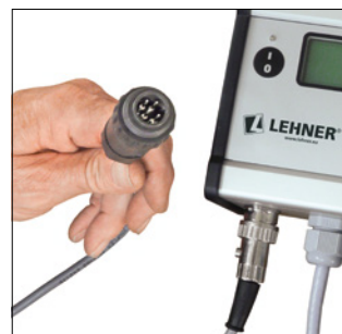
Vorgewendemanager (VGM) 7-polige Signalsteckdose – Schieberautomatik beim Senken bzw. Heben der Hydraulik.
