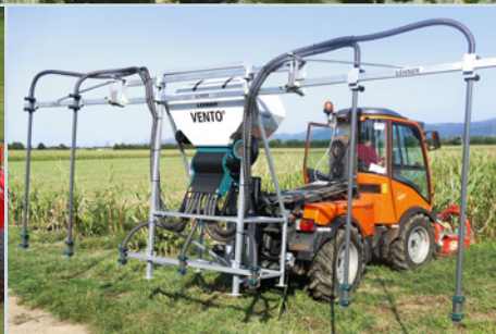
Sonderanwendungen dank 12V-Antrieb möglich
