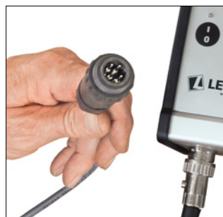
Vorgewendemanager (VGM) 7-polige Signalsteckdose – Schieberautomatik beim Senken bzw. Heben der Hydraulik.
